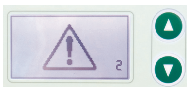
Figura 2-3: Messaggio a display in caso di guasto della ventola.
