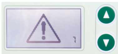
Slika 2-2: Prikaz na zaslonu u slučaju greške u radu LED modula.
