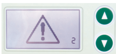
Slika 2-3: Prikaz na zaslonu u slučaju ispada ventilatora kućišta.
