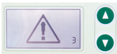
Slika 2-4: Prikaz na zaslonu u slučaju porasta temperature iznad 60 °C.
