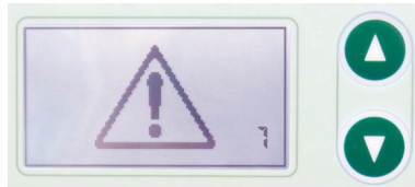
Εικόνα 2-2: Ένδειξη οθόνης σε περίπτωση σφάλματος της μονάδας φωτοδιόδου.
