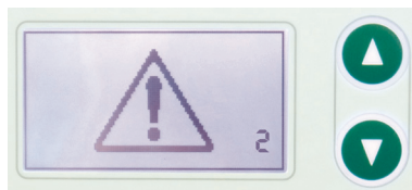
Εικόνα 2-3: Ένδειξη οθόνης σε περίπτωση αστοχίας του ανεμιστήρα περιβλήματος.
