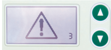
Εικόνα 2-4: Ένδειξη οθόνης σε περίπτωση αύξησης της θερμοκρασίας άνω των 60 °C.
