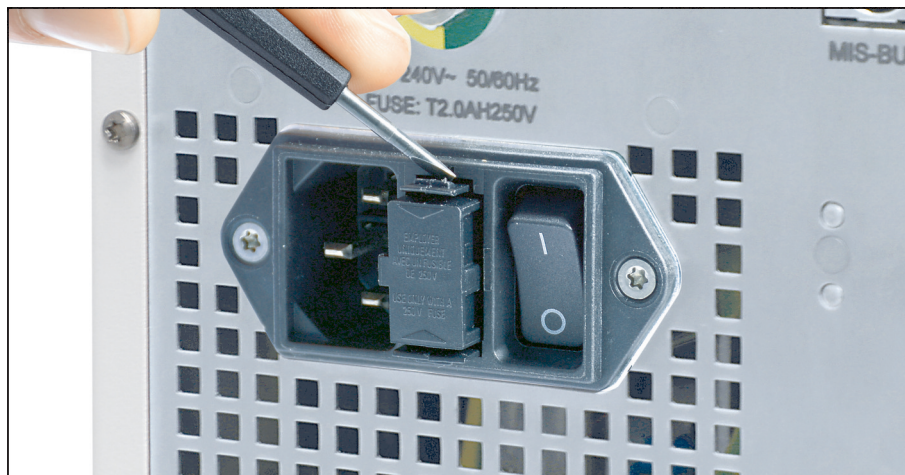
Imagem 7-2: Soltar o porta-fusíveis com auxílio de uma chave de parafusos.
