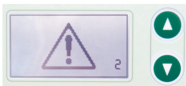
Figure 2-3 : Indication sur le visuel en cas de panne du ventilateur du boîtier.
