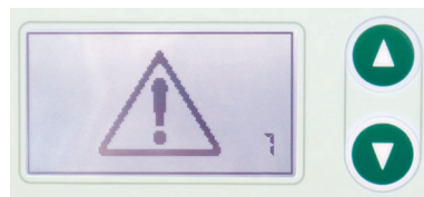
Figure 2-2 : Indication sur le visuel en cas de dysfonctionnement dans le module DEL.
