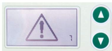
Afbeelding 2-2: Weergave bij storing van de led-module.
