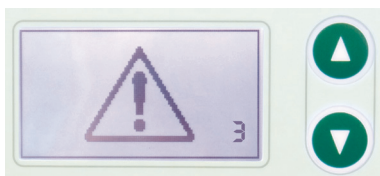
Afbeelding 2-4: Schermweergave bij temperatuurstijging boven 60 °C.
