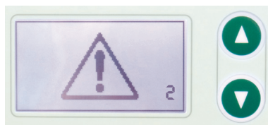
Afbeelding 2-3: Weergave bij uitval van de behuizingsventilator.
