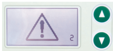
Obrázok 2-3: Zobrazenie na displeji v prípade výpadku ventilátora krytu.
