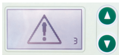
Obrázok 2-4: Zobrazenie na displeji pri náraste teploty nad 60 °C.
