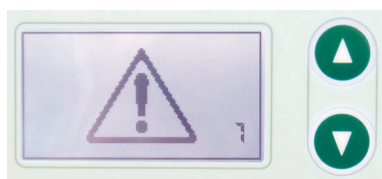
Figur 2-2: Displaymeddelande vid driftfel i LED-modulen.
