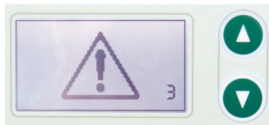
Figur 2-4: Displaymeddelande när temperaturen stiger till över 60 °C.
