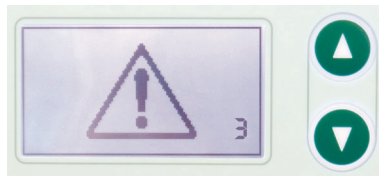
Abbildung 2-4: Displayanzeige bei Temperaturanstieg über 60 °C.
