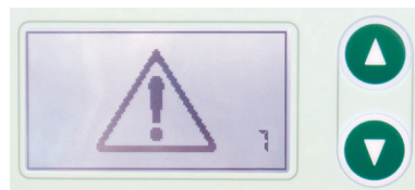
Abbildung 2-2: Displayanzeige bei einem Betriebsfehler im LED-Modul.
