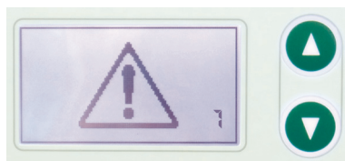
Joonis 2-2: Ekraaninäit LED-mooduli käitusvea korral.
