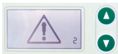
Joonis 2-3: Ekraani näidik korpuse ventilaatori rikke korral.
