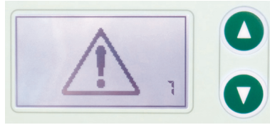
Attēls 2-2: Ekrāna rādījumi LED moduļa darbības kļūdas gadījumā.
