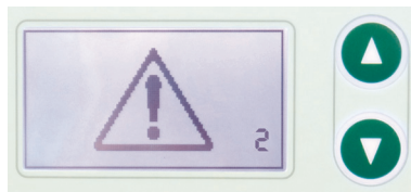
Attēls 2-3: Ekrāna rādījums korpasa ventilatora atteices gadījumā.
