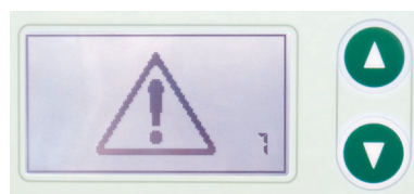
Figur 2-2: Displayvisning ved driftsfejl i LED-modul.
