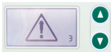
Figur 2-4: Displayvisning ved en temperaturstigning over 60 °C.
