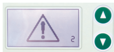
Obrázek 2-3: Hlášení na displeji při výpadku ventilátoru pláště.
