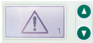
Imagem 2-2: Indicação do visor em caso de falha de funcionamento do módulo LED.
