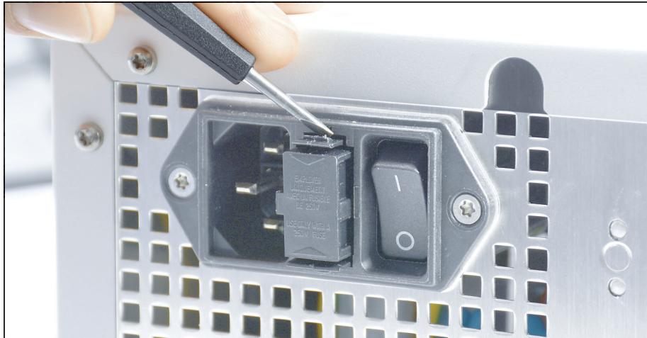
Figur 7-2: Lossa säkringshållaren med hjälp av en skruvmejsel.
