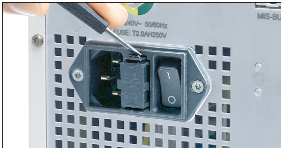
Figure 7-2 : Retrait du porte-fusible à l'aide d'un tournevis.
