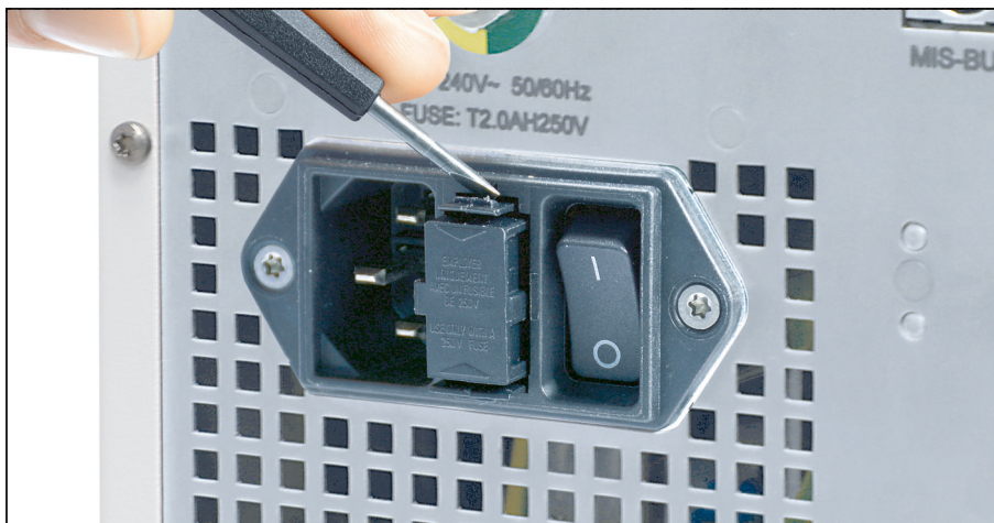
Ilustracja 7-2: Odkręcanie podstawy bezpiecznika za pomocą śrubokręta.
