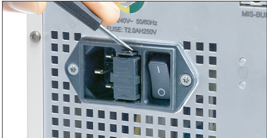
Figura 7-2: Afloje el portafusibles con ayuda de un destornillador.
