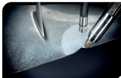
Abtragen von beschädigtem Material und Glätten einer Turbinenschaufel
