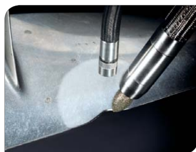
Abtragen von beschädigtem Material und Glätten einer Turbinenschaufel
