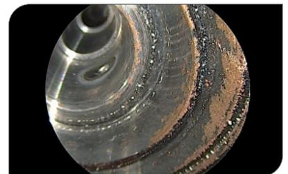
Gute Sicht auf die Seitenwände durch Sonden mit Seitblick
